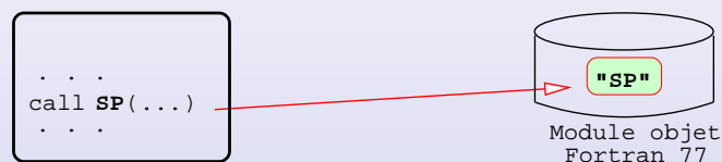
Figure 2 – appel classique d'un sous-progr. SP disponible sous forme d'un module objet sans contrôle inter-procédural
