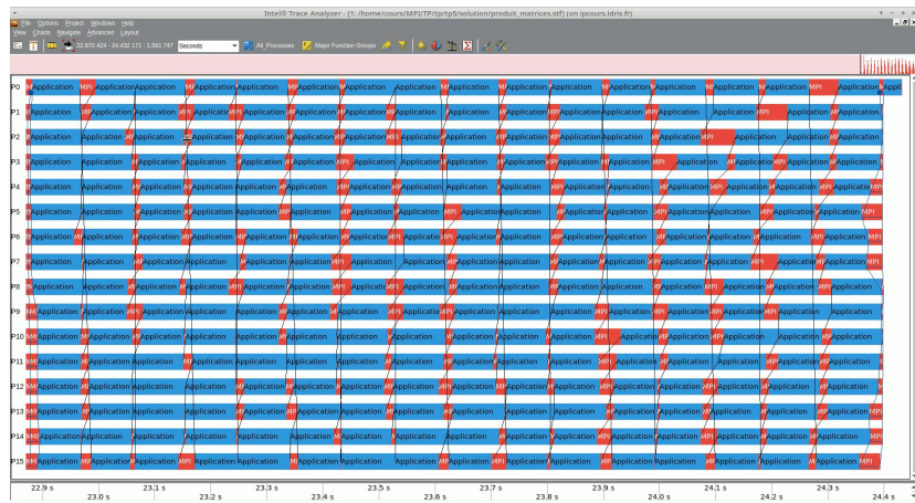
Figure 28 – Produit parallèle de matrices sur 16 processus, pour une taille de matrice de 1024 (second algorithme)
